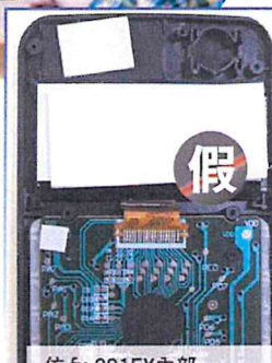
仿 fx-991EX內部 假太陽能板不供電，電池 規格可能不符政府標準， 電路板質差線路不良
